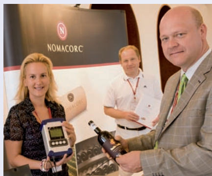
Das PreSens Fibox 3-LCD System, vertrieben von Nomacorc, ermöglicht die Messung des gelösten sowie des gasförmigen Gesamtsauerstoffs in einer (geschlossenen) Weinflasche (Foto: Ziegler)
